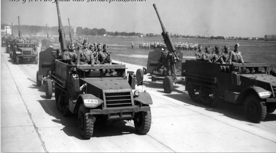
Дефиле противавионске артиљерије 1954. на аеродрому Земун приликом доделе рајних засјава пуковима ЈНА. Возило за вучу је полугусеничар М5 у ЈНА познат као „интернационал“
