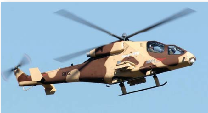
Верзија „ансат 2РЦ“ је лаки извиђачко-борбени хеликоптер, који са основном верзијом дели 90 одсто компоненти
