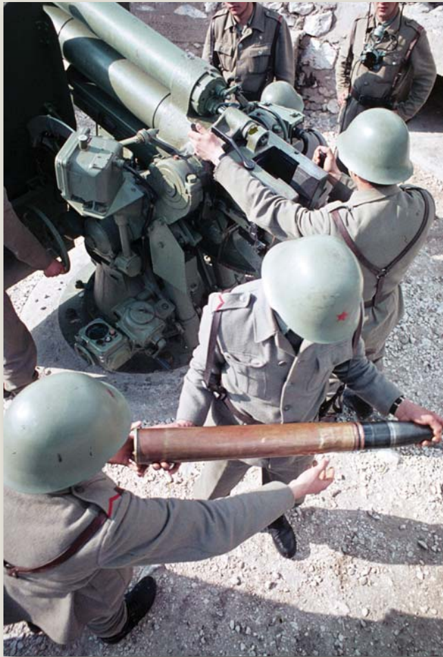
Муниција за оруђа 85 mm била је унифицирана са муницијом за шенк Т-34
